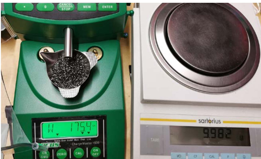
RCBS Charge Master Supreme Pulverfüllsystem und Sartorius Laborwaage für die Feinkontrolle.
